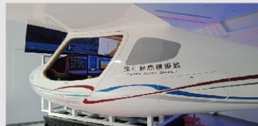
六軸動態飛行模擬機
